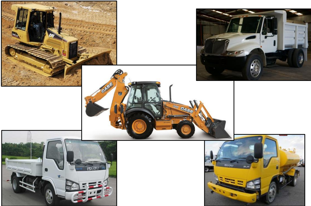
Superior izquierda: bulldozer; superior derecha: camión de volteo; centro: retroexcavadora; Inferior izquierda: camión de 3.5 o 4 toneladas; inferior derecha: camión cisterna.
